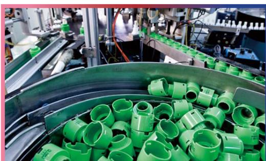
Les cartouches de céramique utilisent des pièces en plastique monobloc injectées directement sous pression pour une qualité constante, et sont assemblées par automatisation pour la standardisation. Chaque article doit subir des tests rigoureux de contrôle qualité et avant l'expédition pour assurer une qualité zéro défaut, y compris des tests de fuites de pression d'air, de cycle, de rupture, de haute température, de haute pression et d'impact intermittent.
