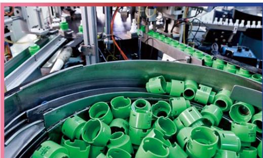
Los cartuchos de cerámica utilizan presión directa inyectada, piezas de plástico de un solo bloque para ofrecer una calidad constante, y se ensamblan mediante automatización para su estandarización. Cada elemento tiene que pasar estrictos controles de calidad y pruebas previas al envío para asegurar cero defectos, incluidas las pruebas de fugas por aire a presión, ciclo, ruptura, alta temperatura, alta presión, y el impacto intermitente.
