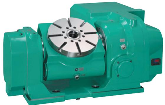
O CNC das séries TRT-de mesas rotativas inclináveis da empresa apresentam um controlador de motor de dois eixos de transmissão com dupla rosca, operação de incremento contínuo 0,001 e sistema de fixação hidráulica (APS reforço disponível), com um maior ângulo de inclinação para um melhor funcionamento. A série NCT de mesas rotativas CNC trabalha em ambas posições verticais e horizontais.
