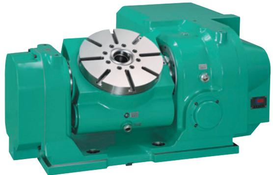
La série TRT de tables rotatoires inclinables CNC de la société dispose d'un plateau tournant à deux axes avec une transmission principale double, 0.001 d'opération d'accroissement continue, un système de serrage hydraulique (Accélérateur PHC disponible) et un angle d'inclinaison plus large pour une opération améliorée. Sa série NCT de tables rotatoires CNC fonctionne aussi bien avec un centre d'usinage vertical qu'horizontal.
