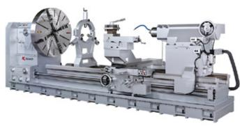
加工ベッドは、誘導、硬化、摩擦加工などと一体化されたハイトルクや、ミーハナイトダイカスト鉄で作れています。すべてのシリーズは、オイルパイプ、航空宇宙、重量級シャフト製造など重工業で使われる巨大な製品や鋼鉄製ロッドを切るための理想的な道具となっています。
