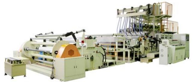
PLASTIC EXTRUSION FILM MAKING MACHINE
