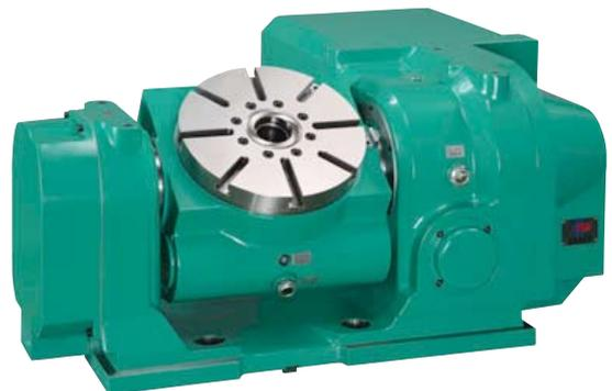
ーター数値制御）傾斜円テーブルのTRTシリーズには二軸モーター駆動で、複数のウォームギア、ウォームホイールを採用し、最小割り出し精度0.001度、油圧ロック装置（PHCアンプがオプション）、超広汎的傾斜軸加工範囲、幅広い加工範囲に適用です。また、NCTシリーズは縦横型対応可能です。
