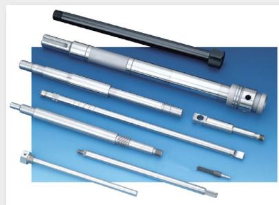
Точность обработки штифтов: 0.005mm~0.01mm по вертикали, 0.005mm~0.01mm параллельно, 0.006~0.01 mm по длине, Ra0.05~0.2 - шероховатость на концах.
