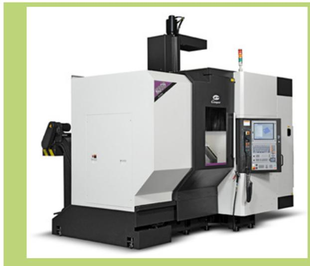
该公司最新的产品是PV系列CNC龙门型立式加工中心。该机种门柱与底座采用一体成型铸件，底座两侧配置一体铸造螺旋排屑器，另外采用三轴结构优化对称设计，X/Y轴以超重负荷滚柱线轨，因此具有非常好的稳定性及刚性表现。该机台的自动润滑功能也可帮助客户提升生产效率。
