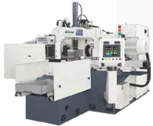
该公司自1996年开始研发CNC双侧加工式铣床，并在2003年正式推出了该机台。为了应付国际市场对于大型机台渐增的需求，该公司成功研发了HM系列双侧加工铣床，以「一次设定，四面加工完成」为特色，尤其特别适合塑料与钢模的制作。另外HM-20050DS6系列，则特别适合模具底座和油路块制作。
