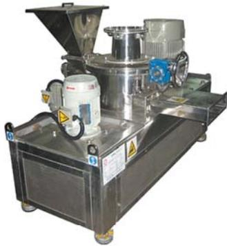
اتساق افضل للشكل في كل نوع من الحبوب التي تنتجها، ويستطيع المستخدمون التحكم بسهولة بحجم الذرات المسحوقة عن طريق ضبط سرعة دوران كثافة الهواء للفاصة ، ان السلامة عززت بنظام تعشيق يحمي اتومتيكيا المشغلين من تشغيل الآلة عندما يكون غطاء حجرة السحق مفتوحا ، ويغلق غطاء الغرفة عندما تكون الالة عاملة ، وتعليمات نقل الفاصلة وديسك الطحن السهلة تجعل الآلة سهلة التنظيف والصيانة ، وتهيتها خاصة لعمليات تستلزم تغيير دائم للمواد الخام المراد سحقها .
