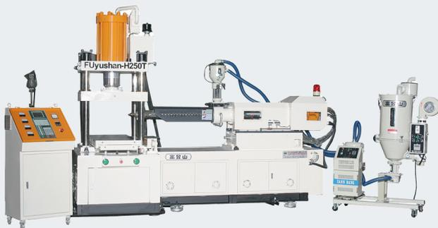
Gracias a sus conocimientos sobre extrusión y moldeo por inyección, la compañía también ha desarrollado extrusoras e inyectoras de hormas de zapatos capaces de producir 6 kilogramos de hormas de zapatos con un molde de configuración en cada ciclo de producción, con un 95% de los productos extruidos libres de burbujas de aire.
